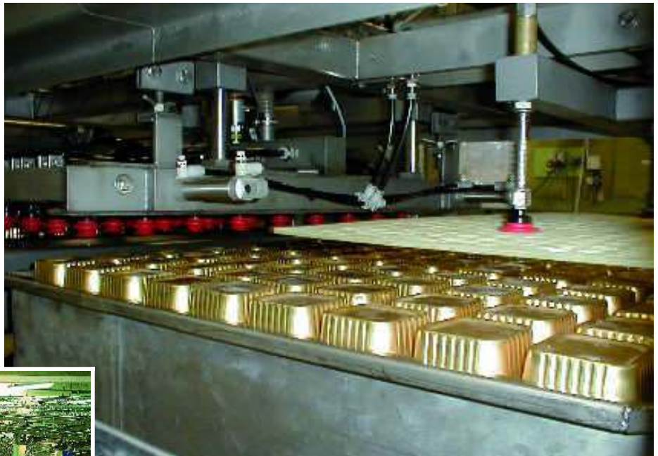
Hochgeschwindigkeitsentladen von Aluschalen mit Katzenfutter mittels Vakuumbechern.
