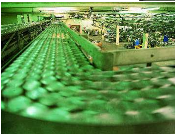
Hochgeschwindigkeitsentladen von Aluschalen mit Katzenfutter mittels Vakuumbechern.
