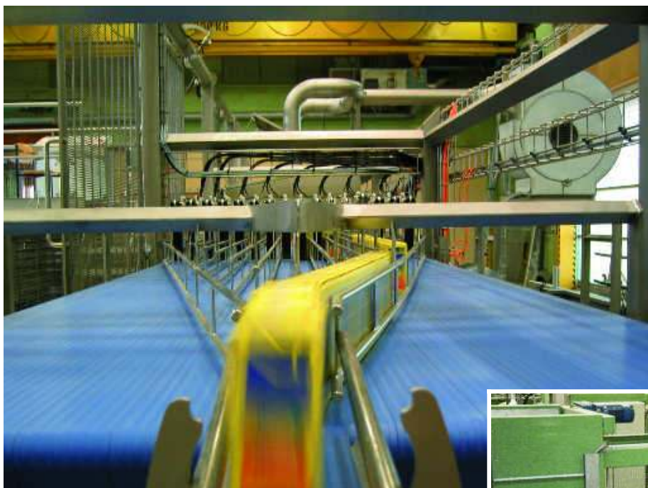
Einzelabfüllung von Convenience-Tierfutter (Tetra Recart) in Hochgeschwindigkeit.
