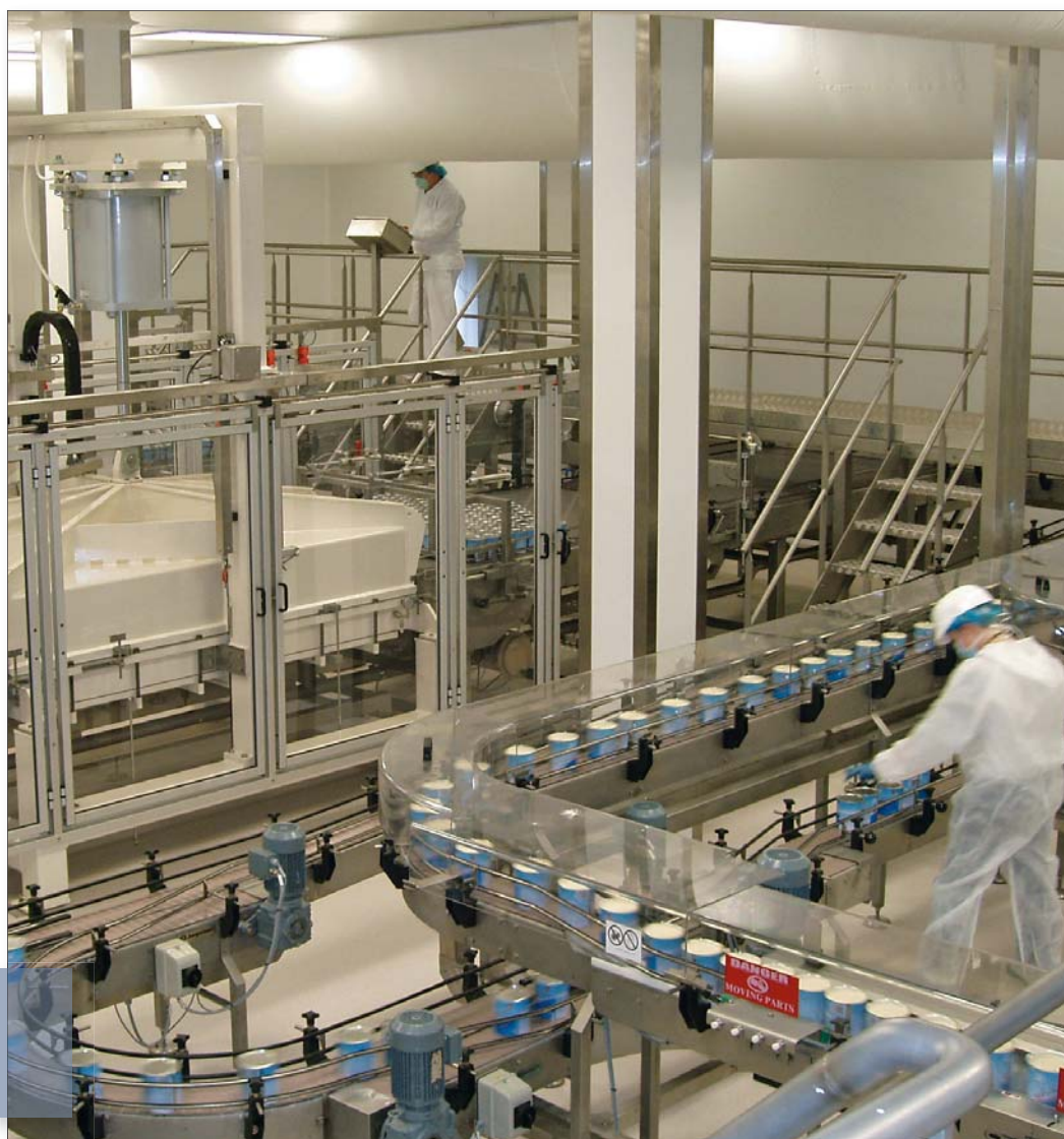
Jorgensens gasenheder med div. conveyors.
